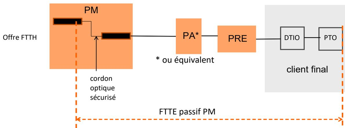
Figure 1 : Synoptique de l'Accès FTTE passif PM
