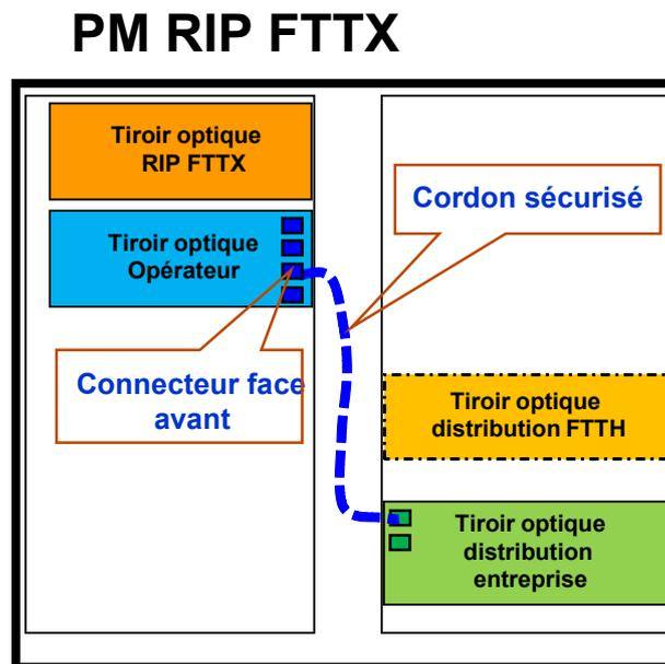
Figure 2 : FTTE passif PM - Raccordement au PM
