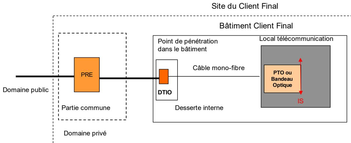
Figure 4 : FTTE passif PM - raccordement sur PRE intérieur
